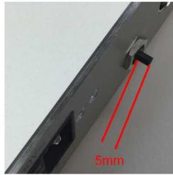
Eine automatische Sicherung (sekundär) löst bei Überstrom aus. Im Normalbetrieb steht der Stift ca 5mm heraus. Nach dem Auslösen ca 8mm.
