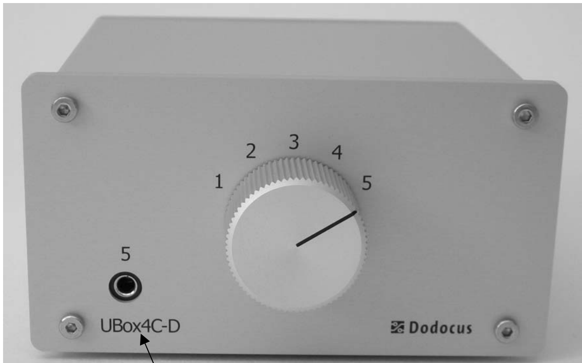
Eingang 5, Klinkenbuchse 3,5mm
