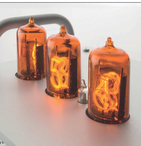
Für das Foto haben wir ein wenig getrickst, um mehrere Ziffern in den Nixieröhren gleichzeitig leuchten zu lassen
